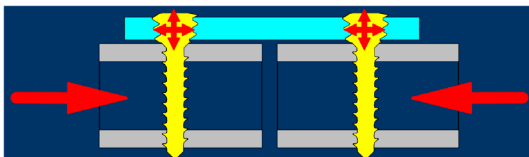
Рис. 2. Схема действия сил при фиксации пластиной с угловой стабильностью.
